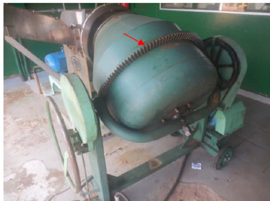
Figura 14: Betoneira sem a proteção da cremalheira.
