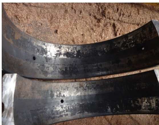
Figura 11: Inspeção – Rolamento sem lubrificante.
