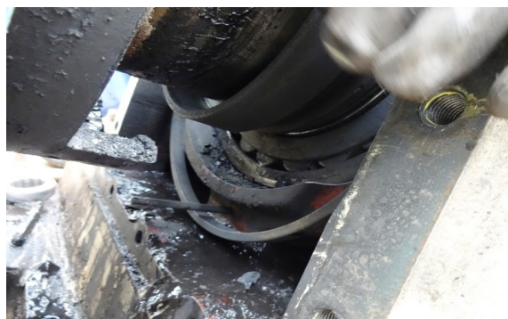
Figura 08: Inspeção - Abertura do Rolamento.
