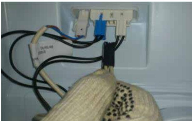
**Fig. 19** – Aplicando a nova resistência de degelo.
