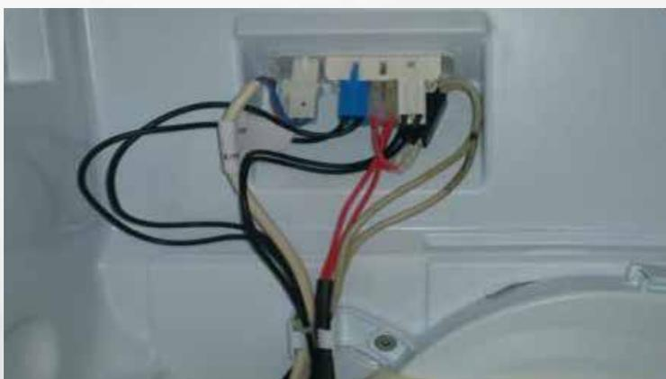
**Fig. 21** – Aplicando a nova resistência de degelo.
