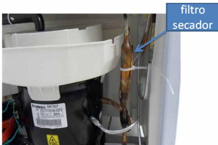
Fig. 4 – vista do filtro secador.
