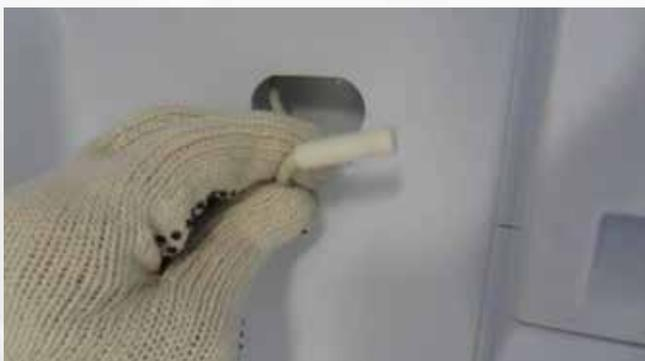
**Fig. 13** – vista de um sensor termistor.
